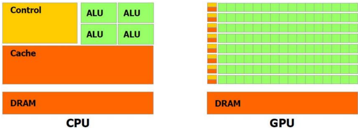
Hình 3.8 So sánh kiến trúc CPU và GPU.
